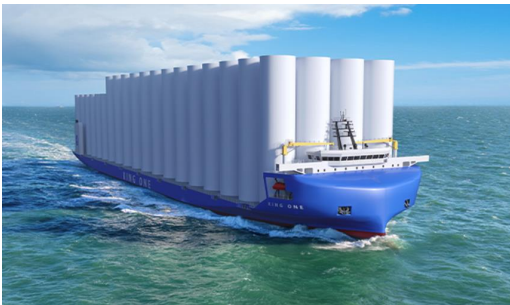
图、首创“立式发运”物流方案并拥有相关专利，超长超宽甲板大大加大直径风机基础桩的单航次装载量，单艘航运船只增量贡献测算：初步测算预计为出口海工产品提供1000元单吨净利增量
