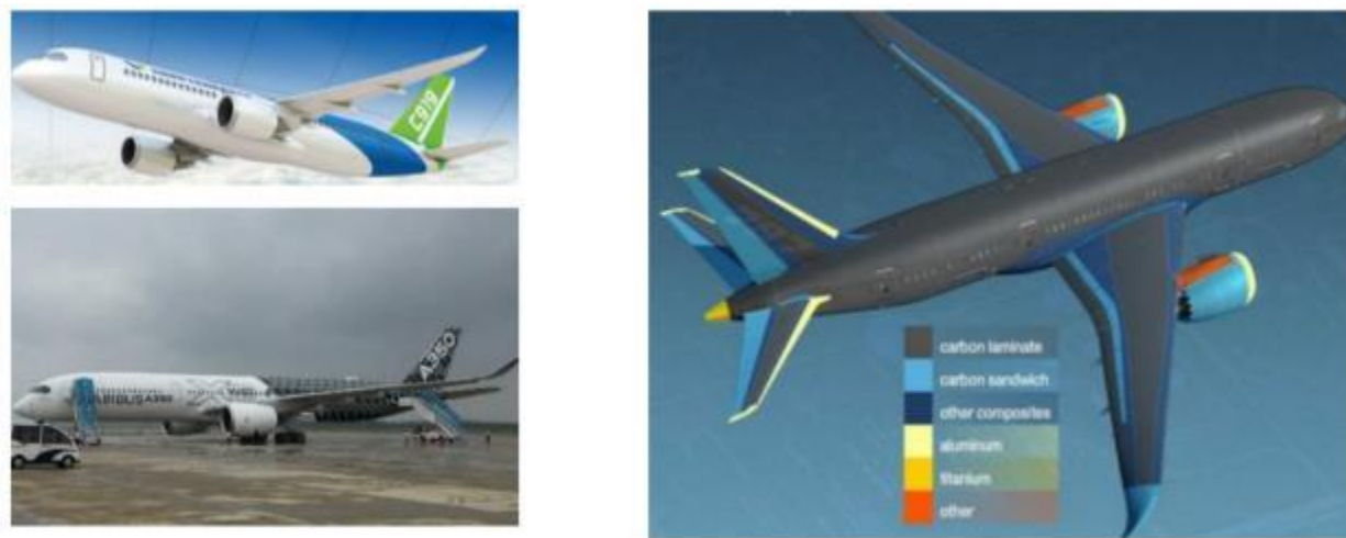
图：C919客机机身结构图
