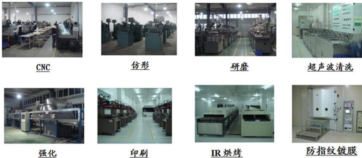
图 41: 盖板玻璃生产工艺流程
