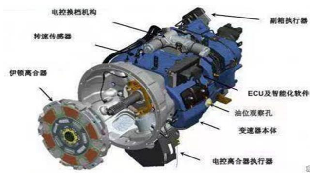
图 17: AMT 变速器结构图
