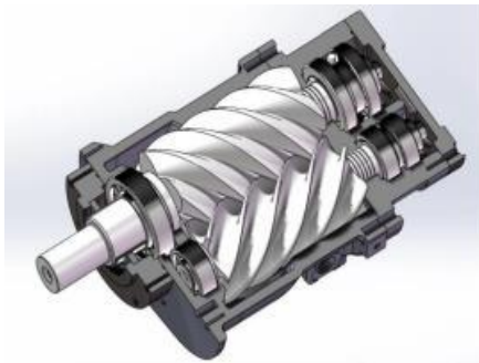
图表 18：螺杆主机内部结构示意图
