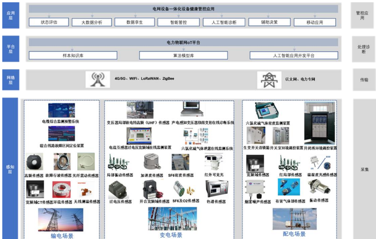
图表 2：产品渗透三大环节：信息采集、网络通信、信息处理和诊断
