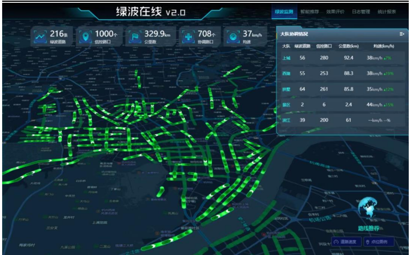
图 24：杭州交警“绿波在线 2.0”系统绿波带运行示意图、
