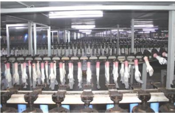
图 21: PVC 手套生产线
