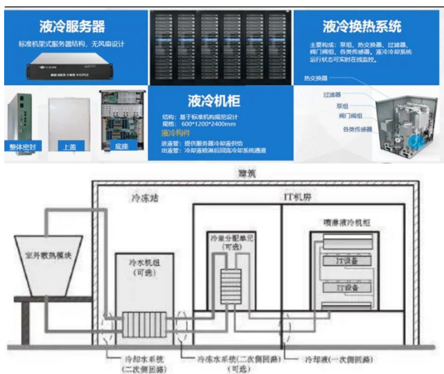
图34：喷淋式液冷系统工艺流程示意图
