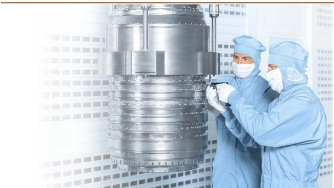
图 14: 光刻投影物镜组实拍图
