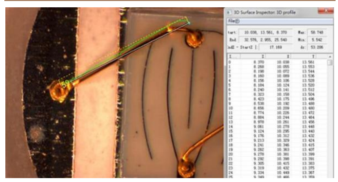
图 17：后道焊点间长度的测量
