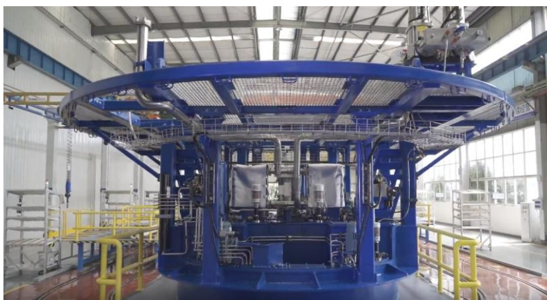
图 27：公司为明阳智能陆上风机配套的 8.0-11.xMW 平台液压润滑冷却综合系统
