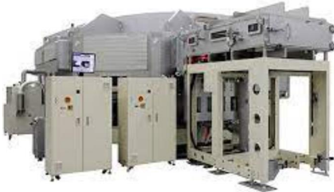
图 28: Tokki 蒸镀机示意图
