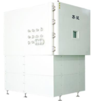
振动、温度、湿度、低气压四综合环境试验系统
