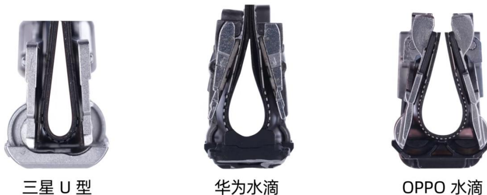
图18: 华为 MateX2、OPPO Find N 提供了较成熟的水滴铰链方案
