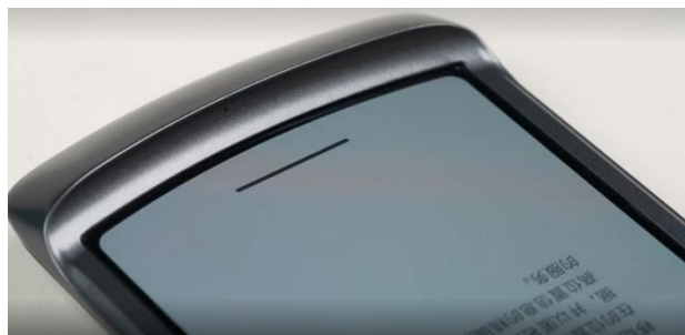
图15: Moto Razr 下巴位置留有较大缝隙
