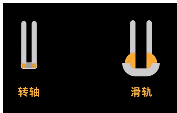
图11: 三星通过滑轨的方式实现屏幕和铰链盖板对齐
