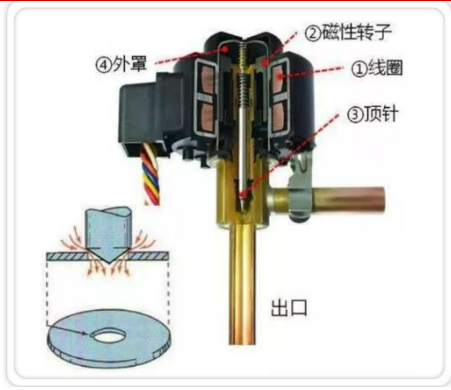
图 5 电子膨胀阀结构
