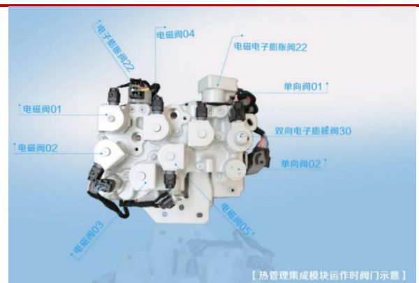
图 23 国内某车型热管理集成模块阀件数量超 9 个
