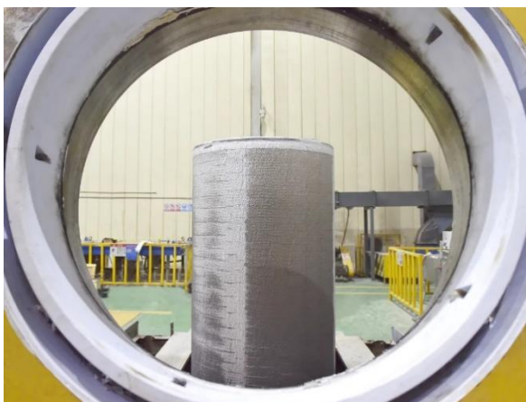
图63: 直径 1400 毫米高强度高韧铝合金圆铸棒正在出炉
