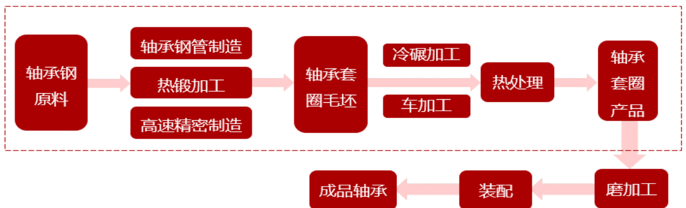
图33: 套圈属于磨前产品，生产工艺要求高
