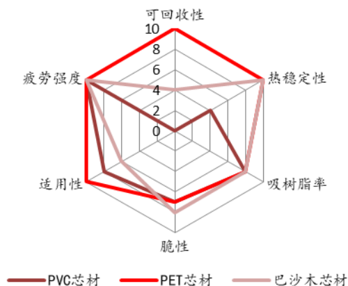
图55 风电叶片主要芯材性能对比
