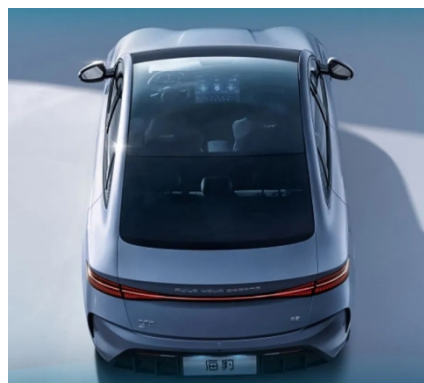
图 19: 比亚迪海豹搭载 EC 调光+LOW-E 全景天幕
