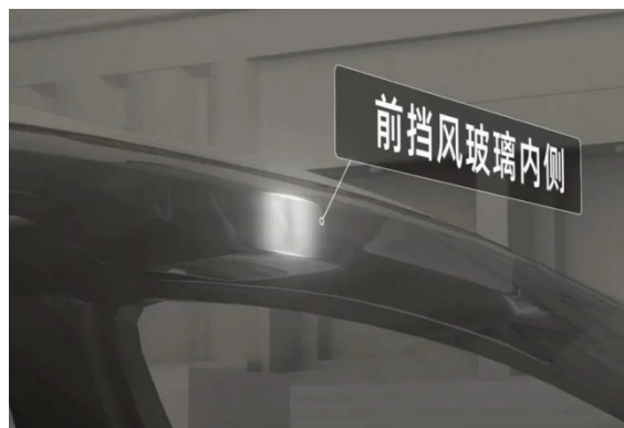
图17：福耀推出激光雷达内置方案——将激光雷达放置于前挡风玻璃内侧
