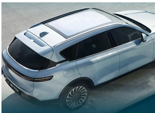
图 18: 岚图 FREE PDLC 调光+镀膜隔热全景天幕
