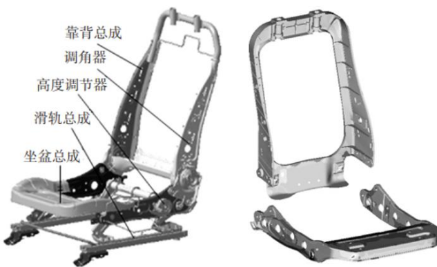
图34: 钢结构座椅（左）与镁合金一体成型座椅
