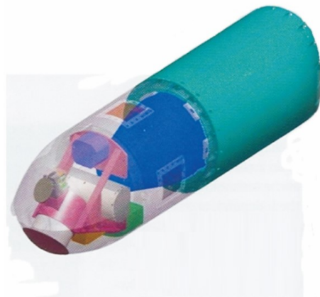
图 13：Raytheon 公司拟配备的毫米波导引头
