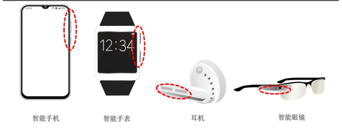
图 36: 超小型防水轻触开关应用例
