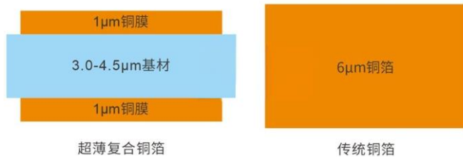
图10.复合铜箔结构图
