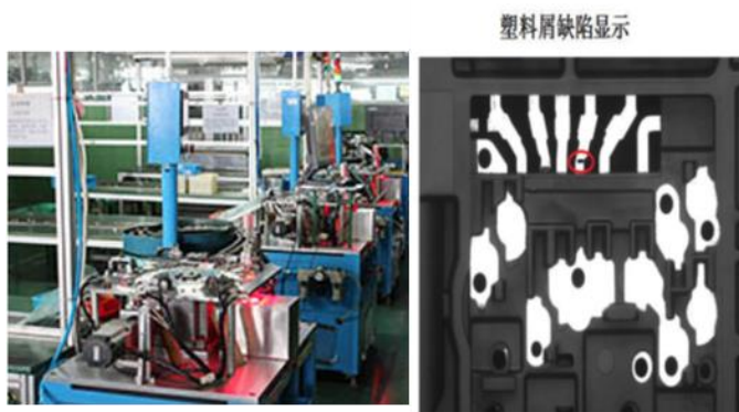
图18.线上 CCD 自动检测设备及产品缺陷检测示例
