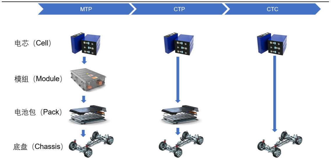
图表 36 新能源电池结构技术从 MTP 发展至 CTP，并向 CTC 模式演变
