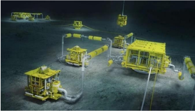
图 38: 深水管汇系统水下作业示意图
