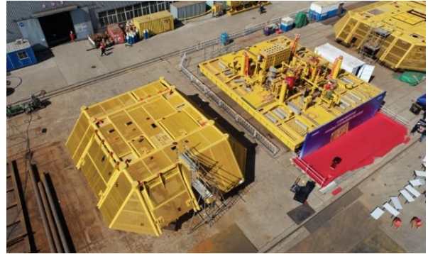
图 39: 深水水下多功能管汇系统天津交付现场
