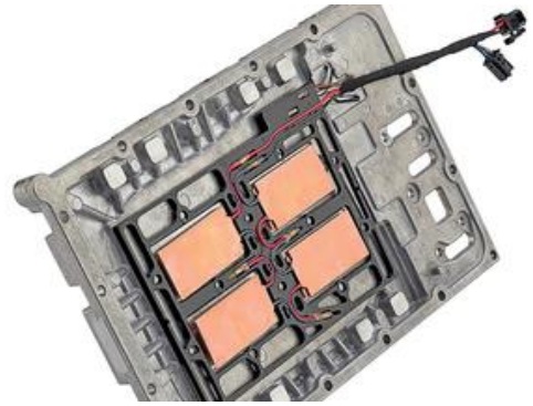
图 46：戴姆勒 48V 轻混电池系统中采用了 4 组半导体热电器件
