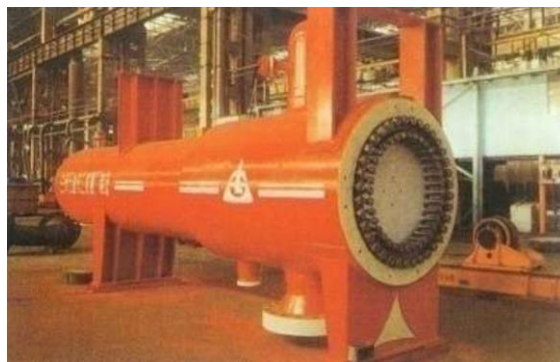
图 16：中石化镇海炼化分公司生产的 180 万吨/年蜡油加氢脱硫装置螺纹锁紧环式高压换热器
