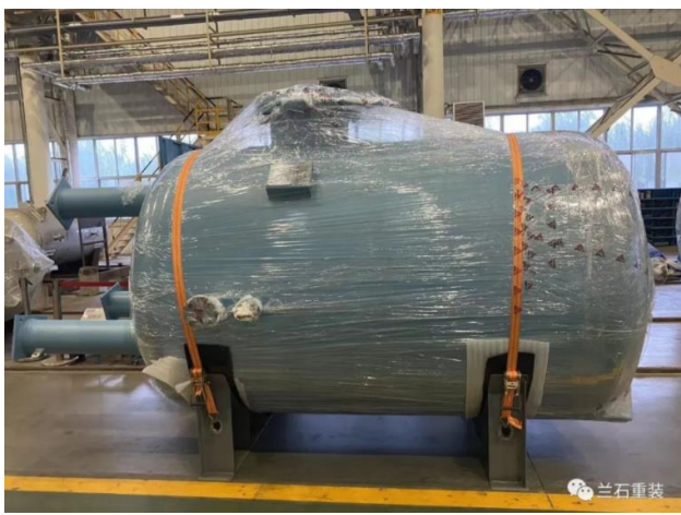
图 35：压缩空气缓冲罐
