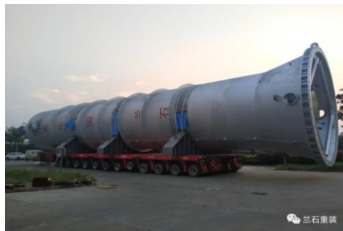
图 18: 苯乙烯脱氢反应器
