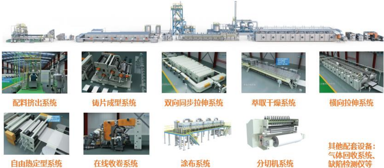
图 21：一条完整的锂电隔膜生产线涵盖挤出、拉伸、萃取等多个环节
