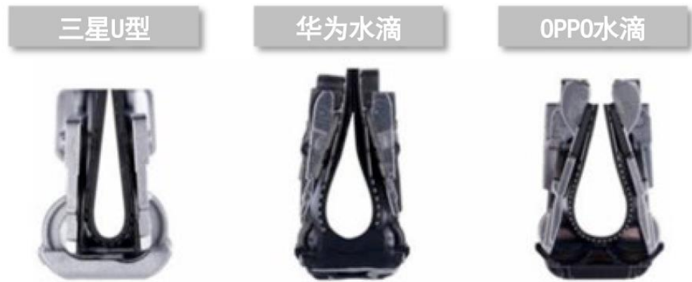
图24. 手机厂商常用三种铰链结构
