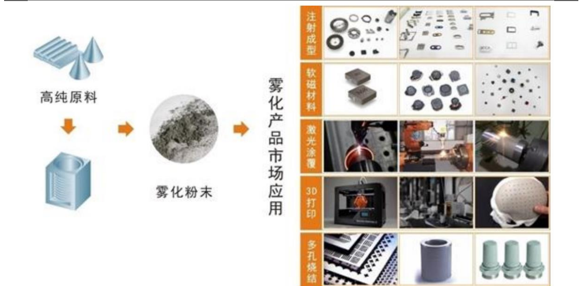
图2. 雾化合金粉制备流程及应用领域概览
