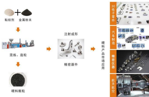
图3. MIM 喂料制备流程及应用领域概览
