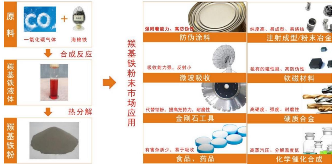
图1. 羰基铁粉制备流程及应用领域概览
