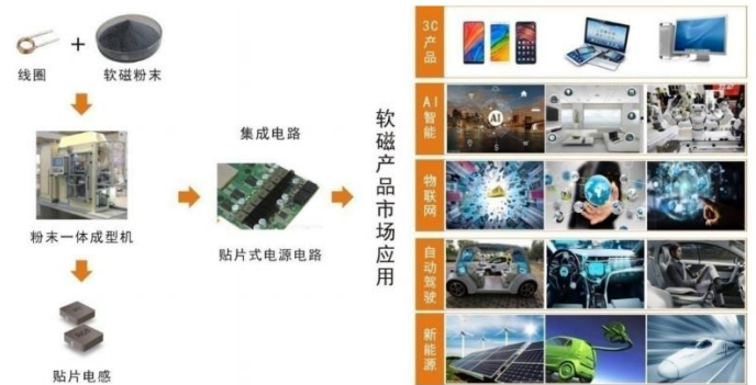
图4. 软磁材料制备流程及应用领域概览
