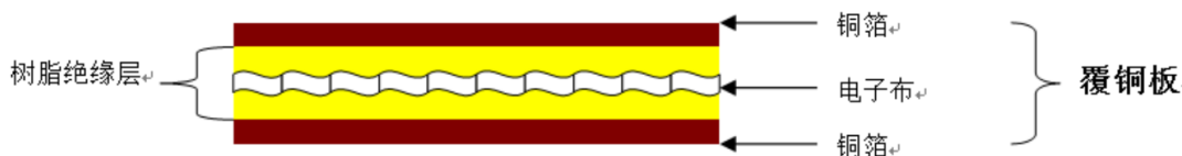
图表 13. 玻璃布基覆铜板结构
