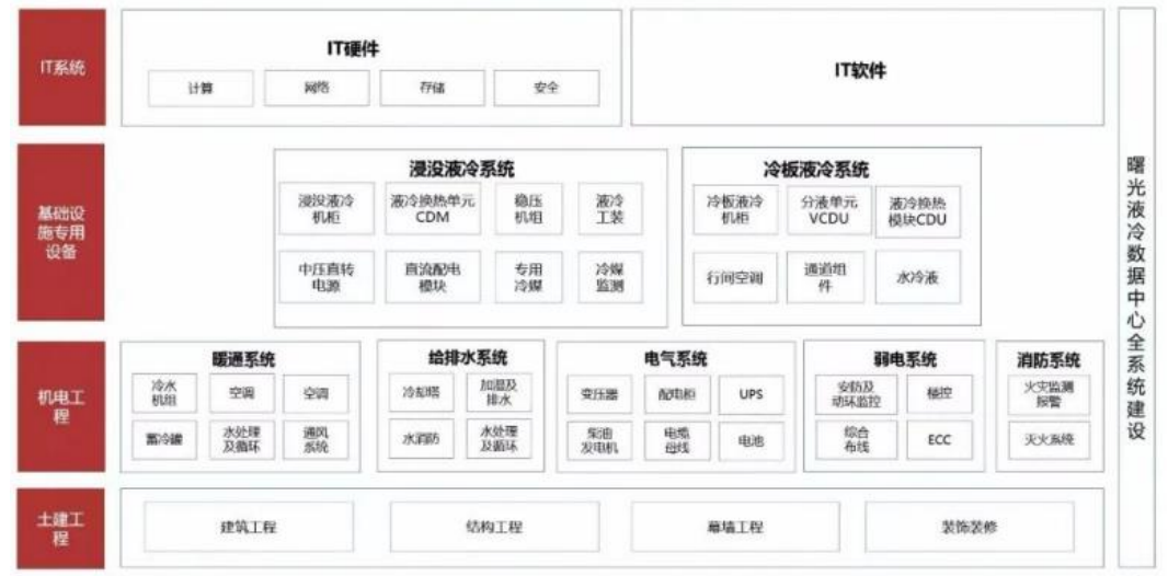
图30：曙光全栈液冷建设方案
