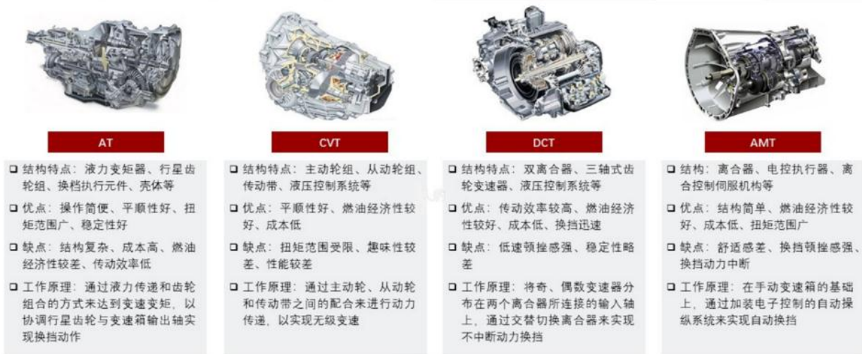
图 21：汽车变速箱结构特点、优缺点及原理
