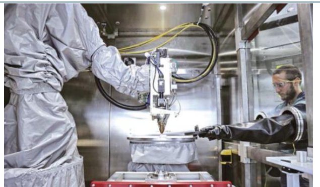
图表38: Avio 航空希望能够用冷喷涂技术替代传统的修理技术
