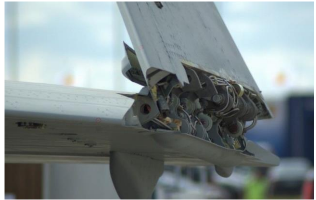
图表26: 俄罗斯米格-29K 舰载机折叠机翼构造
