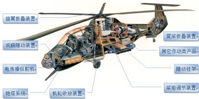
图表3：公司产品在直升机上的应用示意图
