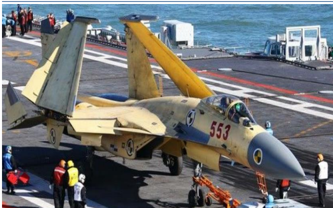
图表23： 中国歼-15 舰载机折叠机翼构造
