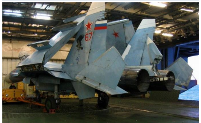
图表24： 俄罗斯苏-33 舰载机折叠机翼构造
