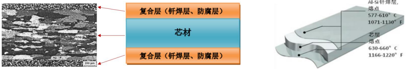
图表 25: 钎焊铝合金复合材料“三明治”结构
