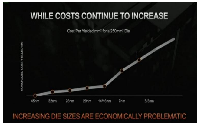
图 45：工艺制程节点与成本的对应关系
