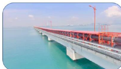
印尼爪哇工程圆管带式输送系统
