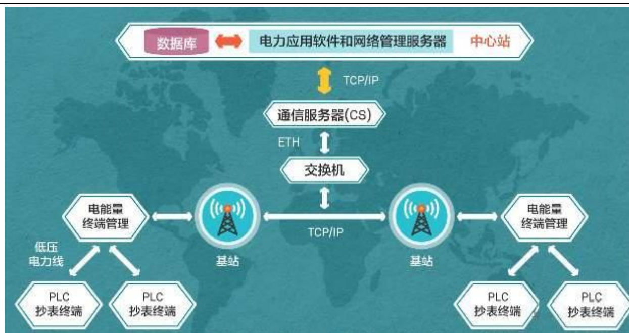
图 24: PLC 实现用电信息采集
