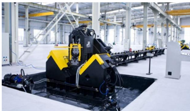
图 8 华明装备铁塔制造数控角钢转孔生产线
