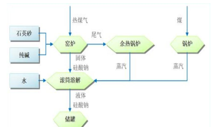
图 19: 元力股份干法生产硅酸钠流程
