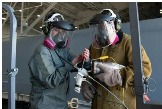
图 18: B1 轰炸机冷喷维修
