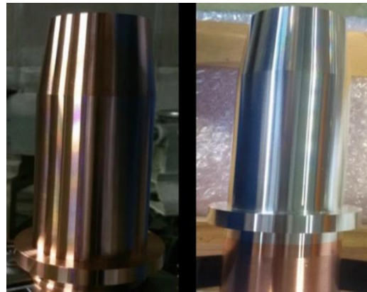
图 23：用于多晶硅制造的电极上的冷喷涂银涂层
