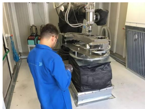
图 20: GE90 喷气发动机变速箱冷喷维修
