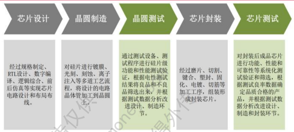
图表 8：集成电路产业链各环节
