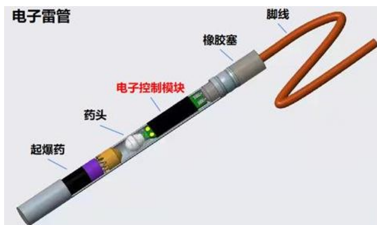
图 1：电子雷管结构拆分
