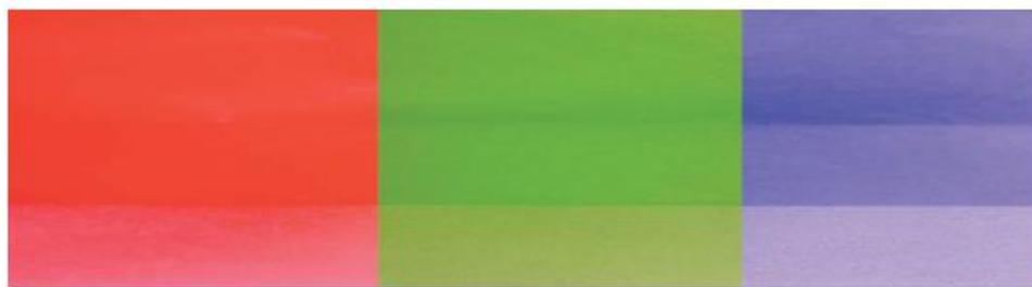
3 Pass打印（底层 1 Pass，中层 2 Pass，上层 3 Pass）
