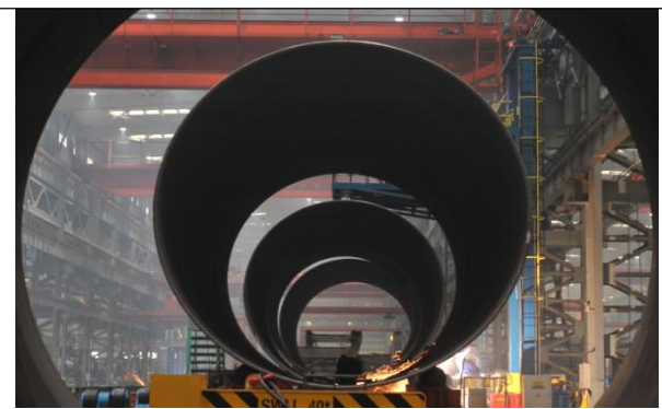
图12: 海上风电单桩基础制造
