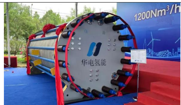
图 13：公司 1200Nm 3 /h 碱性电解槽产品
