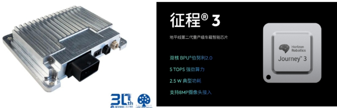
图22: 星宇股份基于地平线征程®3 车规级芯片研发的“行泊一体”解决方案
