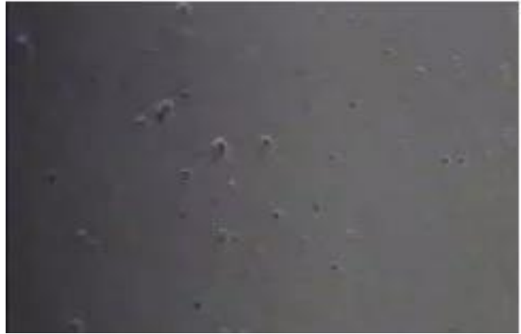
图表 32：涂层出现针孔示意图
