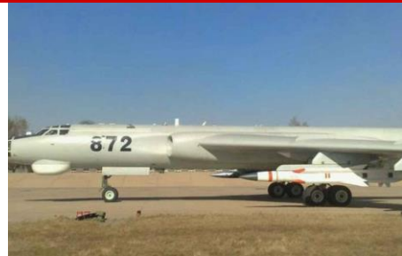
图 31 轰-6 轰炸机挂载鹰击 12 导弹
