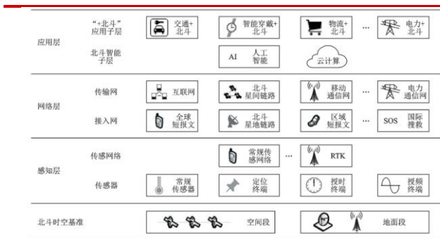
图 10 基于北斗系统的物联网技术架构示意图
