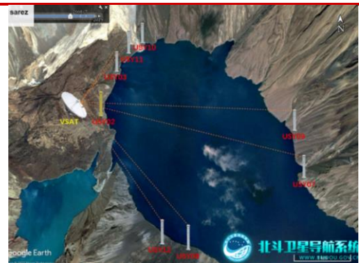
图 35 中塔共建的萨雷兹湖大坝北斗变形监测系统升级运行
