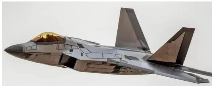
图表 17: F22 最新型号开始贴有片状的隐身材料面板
