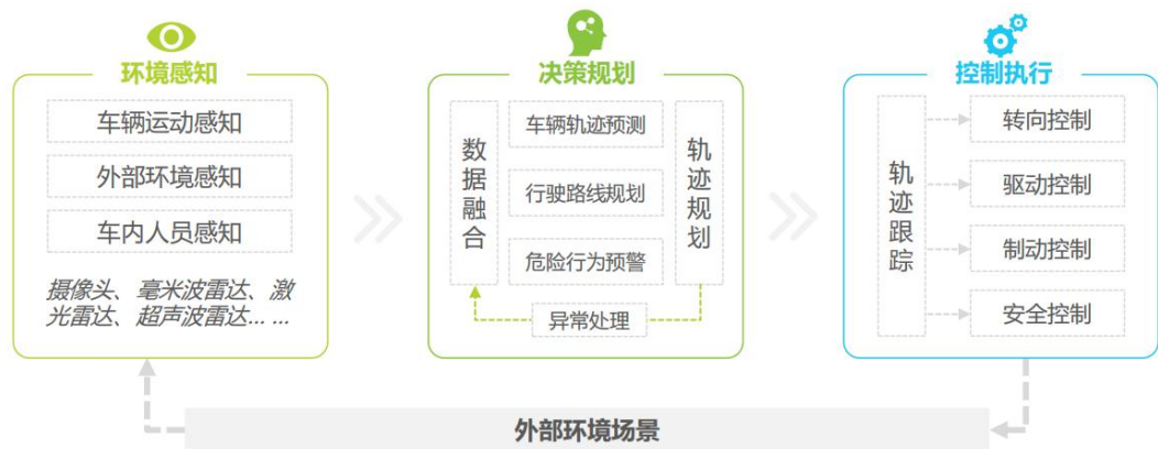
图 43：智能驾驶系统架构
